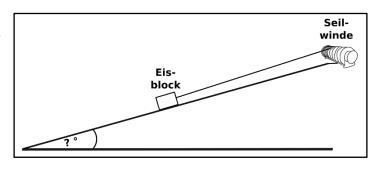
a) Berechne den Winkel der schiefen Ebene, wenn die Seilwinde mit einer Kraft von 100 N ziehen muss. (4 *Punkte*)
